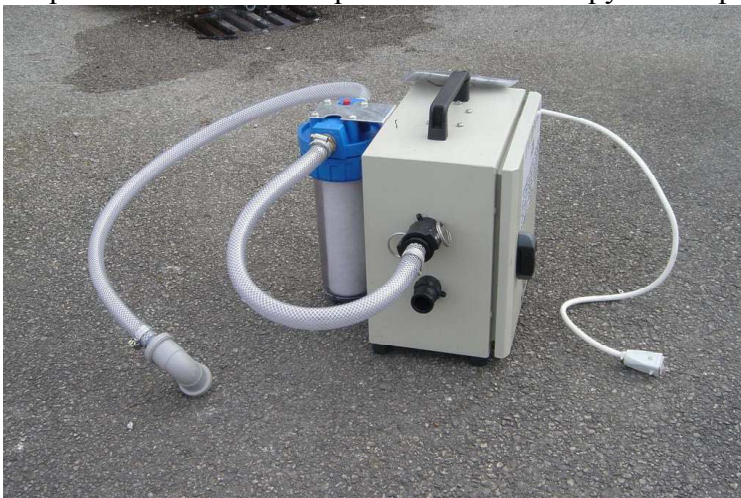
Слика 8.1. Филтрирање воде за јединицу за деконтаминацију. Фотографију обезбедио HSE, Велика Британија
